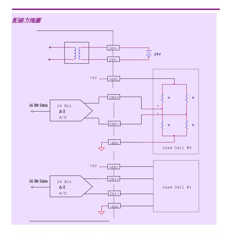
原始A/D轉換的結果是以帶正負號的16位元數表示.經過滿刻度參數的設定及零參考點與滿刻度點的調校程序後.系統會自動將原始的16位元讀值轉爲對應的工程重量值.
